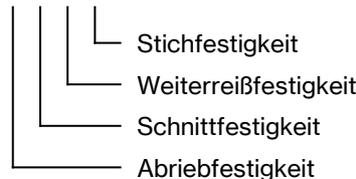
Piktogramm und Leistungsstufen nach EN 388 : 2003 (höchste Leistungsstufe: 4, bei Schnittfestigkeit: 5)
